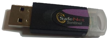
Рис. 2.7. Старая модель ключа Sentinel SuperPro
