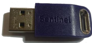
Рис. 2.8. Современная модель ключа Sentinel SuperPro/Sentinel HL
